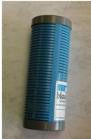
Figuur 3.2 Foto van de gebruikte monstername kokers. In de bovenste kap worden de diffusiebuisjes gehangen.
