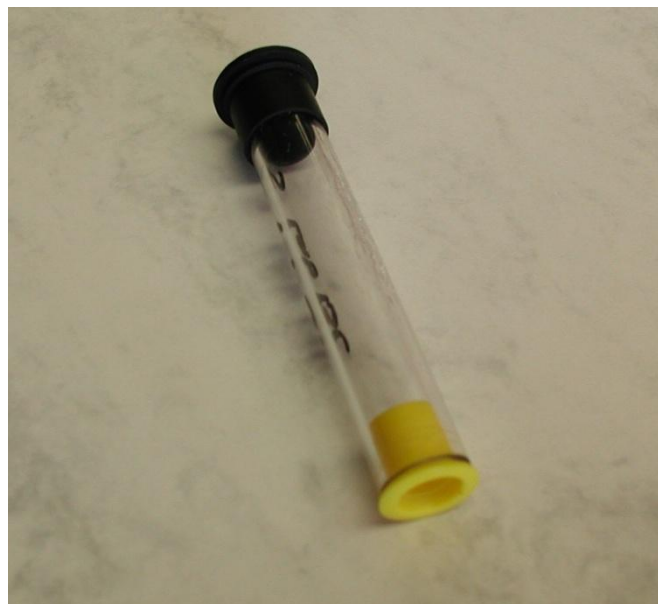
Figuur 3.1 Foto van de gebruikte Palmes diffusiebuisjes. Het reactieve oppervlak bevindt zich in het zwarte kapje. Het gele dopje wordt aan het begin van de meetperiode verwijderd en na afloop weer aangebracht
